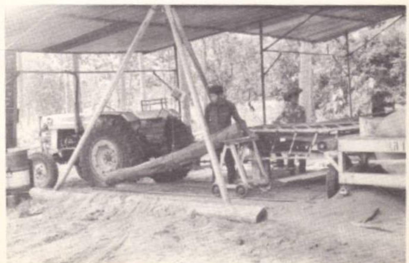
เครื่องกว้านไคช่วยในการยกไม้ขึ้นม้าสำหรับส่งเลื่อยไคโดยใช้คน เพียงคนเดียว ซึ่งตามธรรมชาติของไคต้องใช้คนสองหรือสามคน
